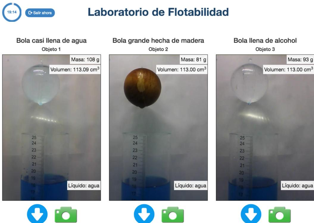
Figura 1. La interfaz de usuario del laboratorio de Flotabilidad.
