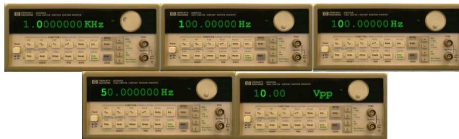
Figura 9. . Generador de funciones. Configuración de la frecuencia y amplitud
