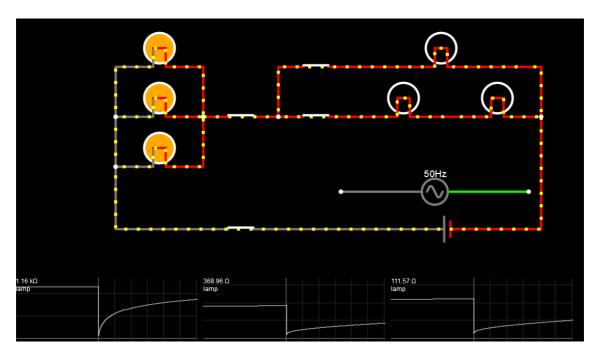
Y en la siguiente se ve el efecto de abrir S4. Se ve que la resistencia de L1 baja y mientras la de L4 sube, tal y como se ha explicado antes.
