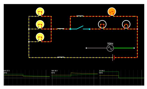
Se ve que al abrir S4 cae drásticamente la corriente en L1 (y el voltaje) y al mismo tiempo sube la intensidad en L4. El comportamiento en L1 se mantiene, mientras que en L4 se da algo curioso: la intensidad empieza a bajar pero la tensión no lo hace, es más, sube, ¿por qué? Pues porque la resistencia está subiendo con la temperatura en mayor medida que la I baja y así V=I·R aumenta.
